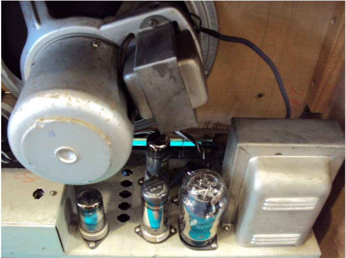
Particolare del trasformatore di alimentazione e l'altoparlante con il suo trasformatore in evidenza le valvole
