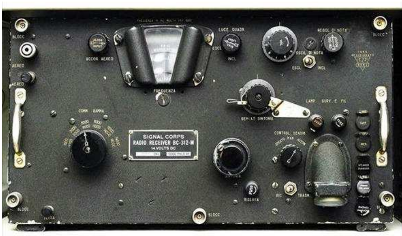
BC-312: RX mitico e leggendario ! Utilizzato da moltissimi radioamatori all'epoca delle stazioni autoconstruite. Copre da 1.5 a 18MHz in AM et CW. E' stato sviluppato nel 1941.
