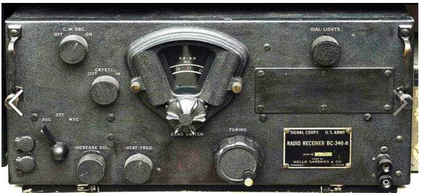
BC-348: RX utilizzato nell'aeronautica durante la seconda guerra mondiale e ancora molti anni dopo. Copre da 200 a 500KHz e da 1.5 a 18MHz. Utilizzato da molti radioamatori all'epoca delle stazioni autoconstruite.
